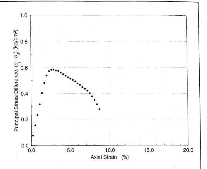
UNCONFINED COMPRESSION TEST ON SPECIMEN FROM BORING SPT-3A, SAMPLE US-2
