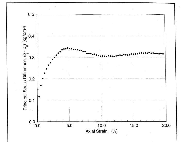
UNCONFINED COMPRESSION TEST ON SPECIMEN FROM BORING SPT-4A, SAMPLE US-1
