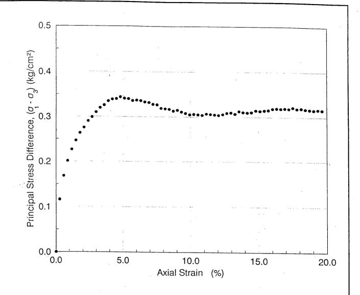
UNCONFINED COMPRESSION TEST ON SPECIMEN FROM BORING SPT-4A, SAMPLE US-1
