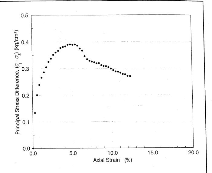
UNCONFINED COMPRESSION TEST ON SPECIMEN FROM BORING SPT-5A, SAMPLE US-1
