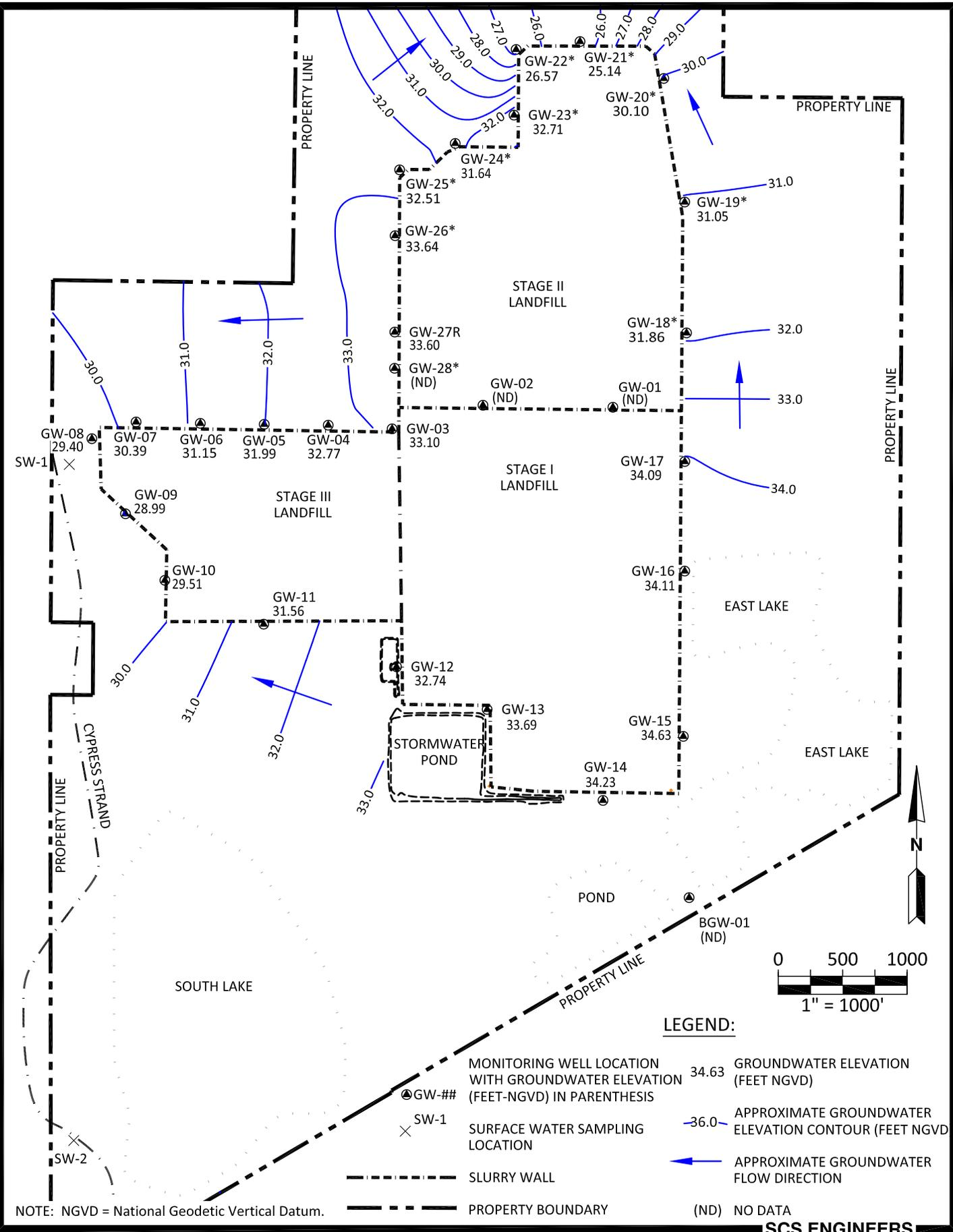
**FIGURE 2-1. APRIL 2020 SHALLOW SURFICIAL AQUIFER GROUNDWATER CONTOUR MAP
