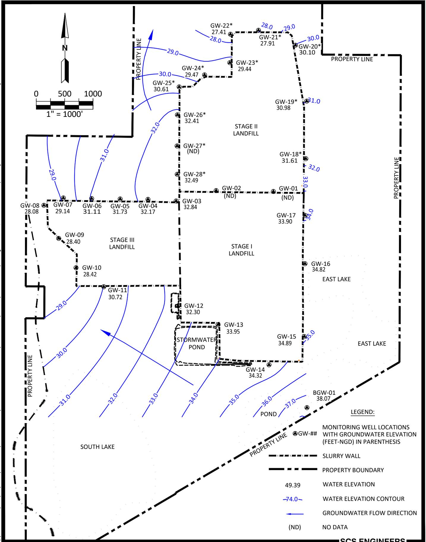
**FIGURE 2-1. NOVEMBER 2018 SHALLOW SURFICIAL AQUIFER WATER LEVEL MAP
