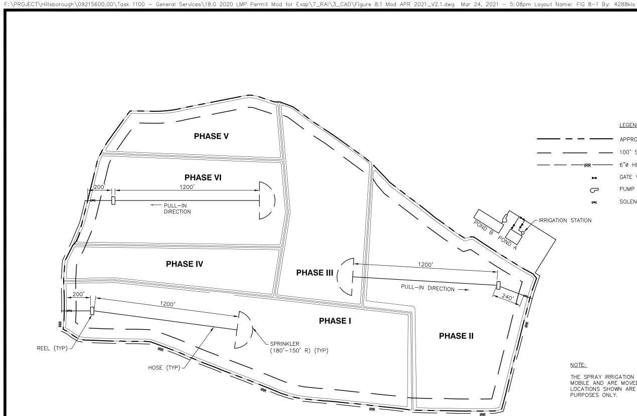
FIGURE 8-1. LOCATION OF PHASE I-VI IRRIGATION SPRINKLER REELS HILLSBOROUGH COUNTY APRIL 2021
