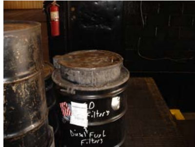
SAA drum -Return/Fill Area
